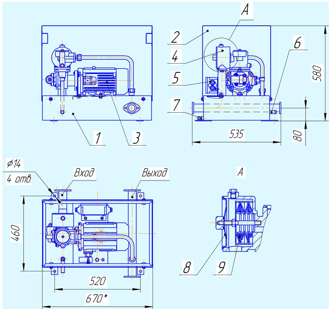
**Рисунок А.1. Габаритные и присоединительные размеры агрегата АНВВ-15**
