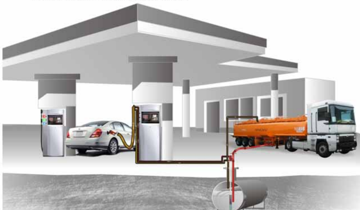
Схема чистой заправки автомобиля и слива продукта из автоцистерны с возвратом паров.
