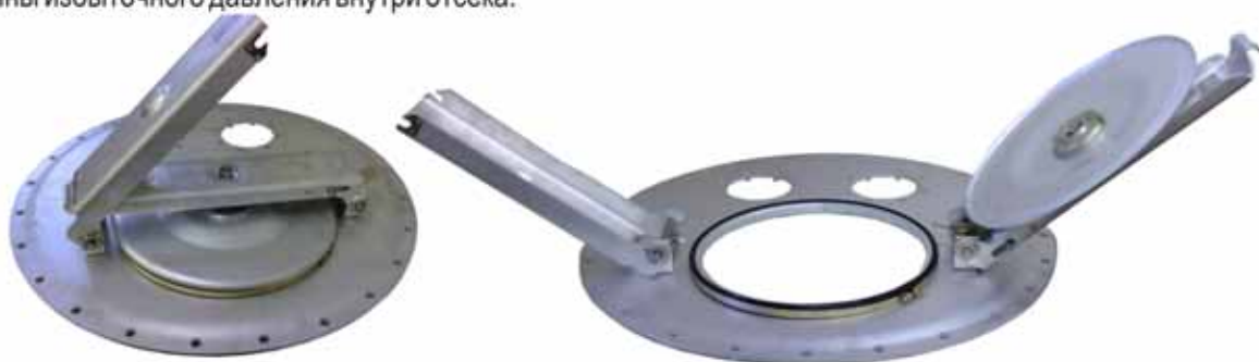
Рис.14. Схема открытия крышки люка автоцистерны
